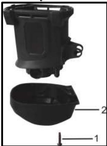
Отверните винт (1) на защитной крышке (2) при помощи отвертки, снимите крышку щетки и извлеките изношенную щетку. Установите новую щетку, крышку щетки и защитную крышку на место.
