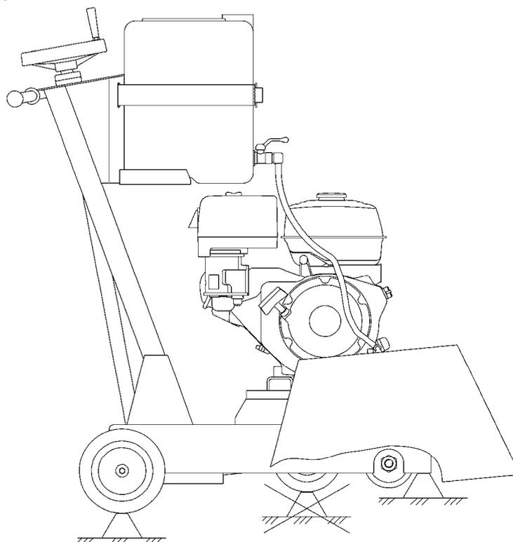
Рисунок 13 – Схема установки резчика при транспортировании
