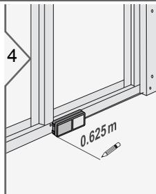
Медленно перемещайте прибор вдоль линии разметки. На дисплее отобразится расстояние до следующей точки разметки.
