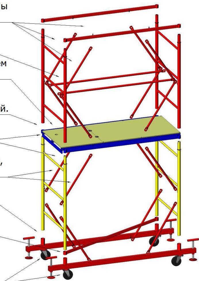
При сборке вышки высотой более четырёх секций, у основания необходимо установить и закрепить стабилизаторы (не входят в комплект поставки) для дополнительной устойчивости.
